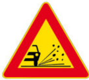
1/390 Materiale instabile sulla strada
