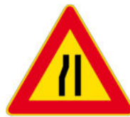
1/385 Strettoia asimmetrica a sinistra
